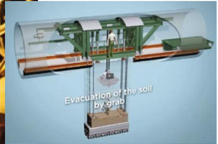
Denys最新发明：沃利机器人用于修筑地下墙体。
